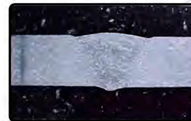
Solda a laser em chapa de aço Maraging.
