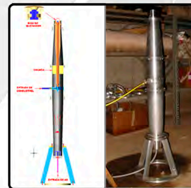
Queimador de combustível líquido (2005). Divisão EFO
