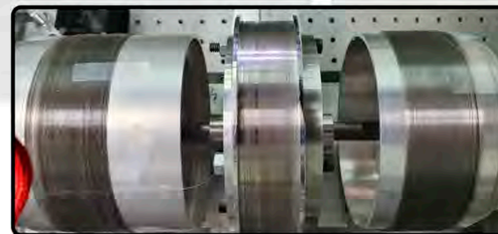
Etapa de enrolamento de fibra óptica para confecção de giroscópio a fibra óptica.
